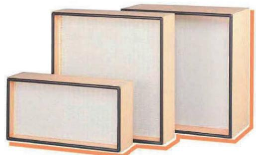
Mutlak filtreler EN1822: 2009'a göre E11 olarak sınıflandırılmıştır. Mevcutta HEPA olmayan bir HVAC kurulumunu HEPA kurulumuna yükseltmek için ideal çözümür. Girintili mini pileli medya yapısı, mutlak filtrelerinin kullanımı ve montajı kolay olduğu anlamına gelirken, yüksek kaliteli MDF kasa sızdırmazlığı ve sağlam gövde yapısını oluşturur.
