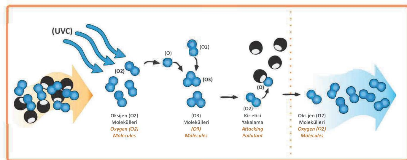
"Koku nötrleştiricileri" olarak da bilinen ünitelerimiz koku moleküllerini parçalamaktadır. Kokuları maskelemeden, yok eder. Bağımsız bir şekilde test edildiğinde ozon (ekoloji ünitemizde kullanıldığı gibi) kokuların %90'ına kadar başarıyla nötrleştirir. [Avrupa Standardı EN13725: 2003]
