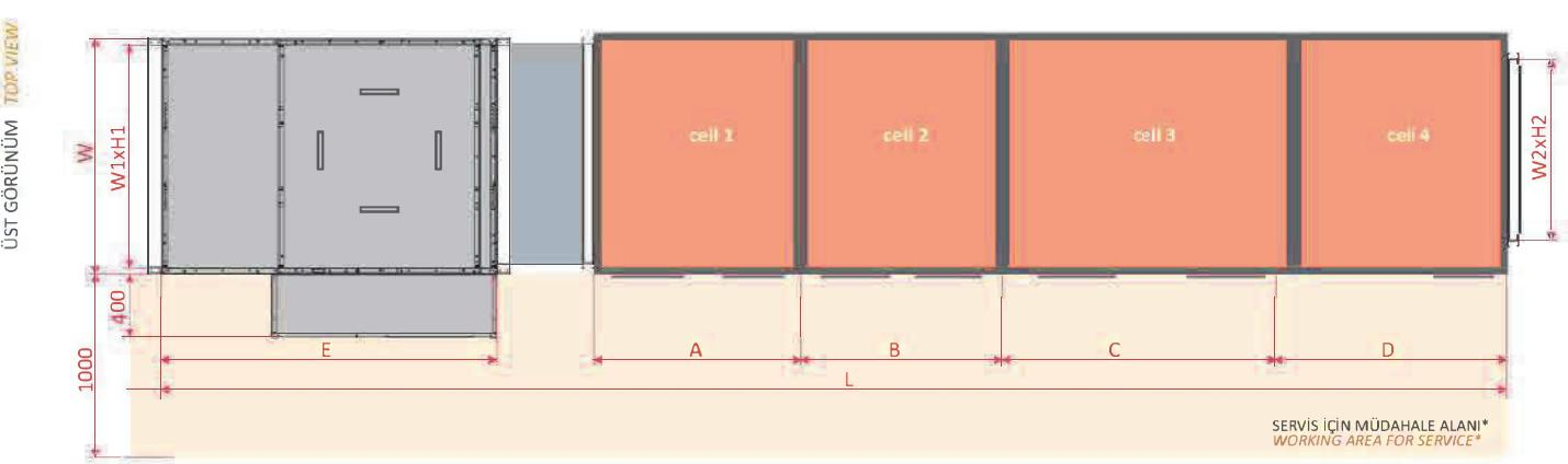
**Hava Yıkama Ünitesi Air Washer** : 1. kademe su duvarı ile is ve kaba taneler filtrelenir, 2. kademe olarak metal filtreler yüksek basınlı su püskürtülerek ince tane yıkaması yapılır. *In the 1st stage, the soot and coarse grains are filtered with the water wall, and the metal filters are sprayed with high pressure water as the 2nd stage and the fine grain is washed.*
