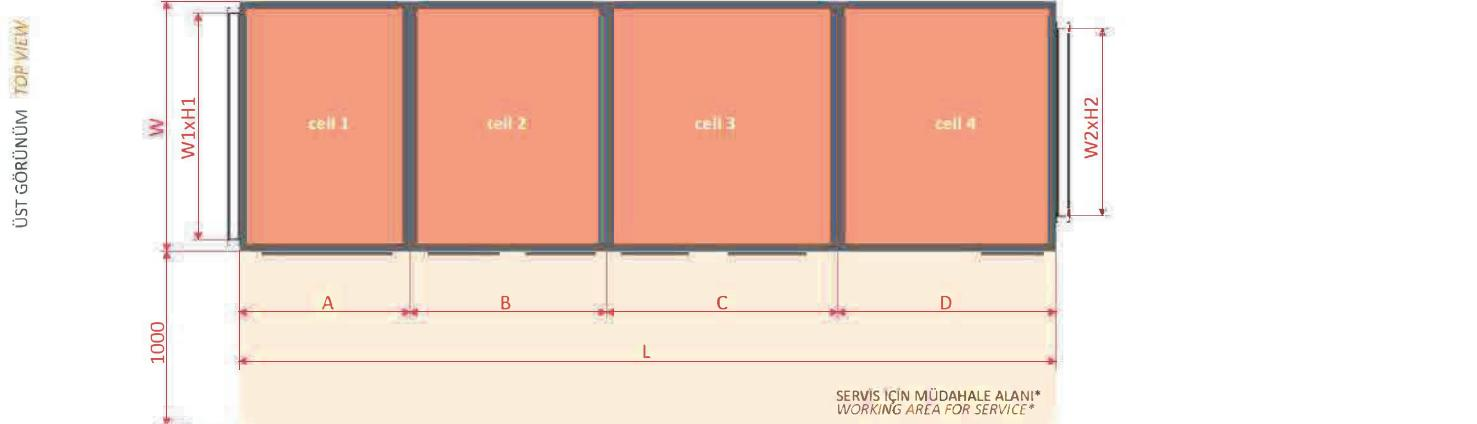
**SEPARATOR** : Yağ ve buhar damlacıklarını süber, köz/kıvılcım atlamalarını öner *Filters oil and vapor droplets, prevents embers / spark jumping*
