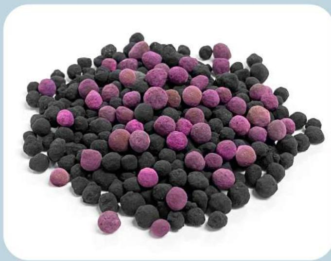
Karbon pellet, gözenekli topaklarda aktif alümina ve diğer bağlayıcıların bir kombinasyonundan oluşur. Potasyum permanganat, çeşitli gaz halindeki kontaminantların optimum adsorpsiyonu, absorpsiyonu ve oksidasyonunu sağlamak için bu ortam kombinasyonuna emprende edilir. Potasyum permanganat pelet oluşumu sırasında eşit olarak uygulanır ve pelet hacmi boyunca dağıtilır. Bu işlem, kimyasal reaksiyon ve optimum performans için maksimum emilim miktarı sağlar.
